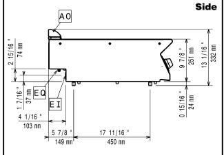
**EI** = Electrical inlet (power) **EQ** = Equipotential screw
